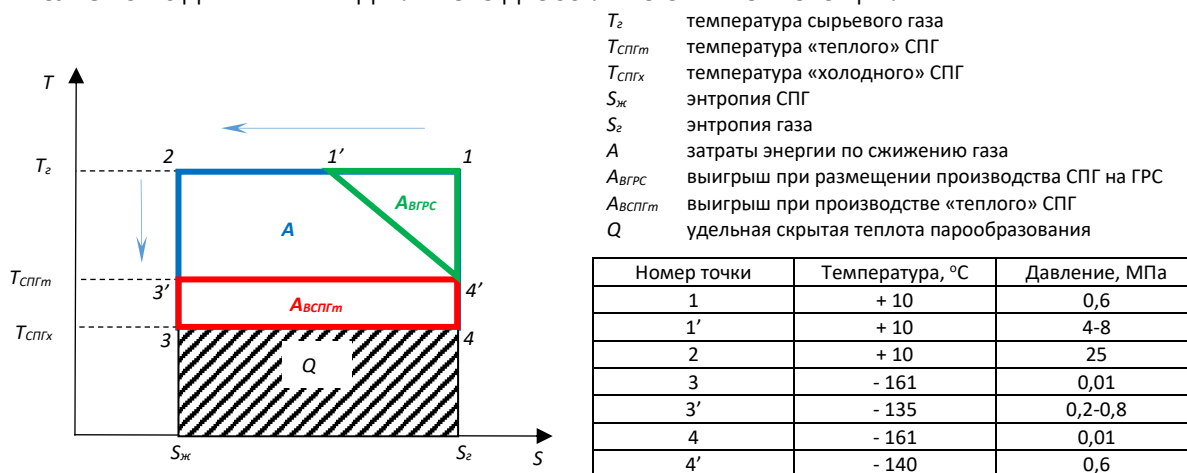
РИСУНОК 3: TS ДИАГРАММА ИДЕАЛЬНОГО ДРОСДЕЛЬНО-ЭЖЕКТОРНОГО ЦИКЛА
